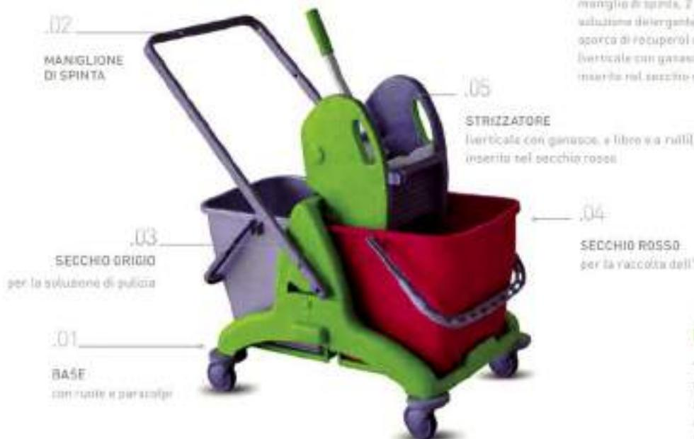
Il carrello strizzatore è normalmente composto da telaio (in materiale plastico o in metallo trattato) con ruote e paracolpi, maniglio di spinta, 2 secchi (blu per la soluzione detergente, rosso per l'acqua sporca di recupero) ed uno strizzatore verticale con ganasce, a fibre e a rulli inserito nel secchio rosso.
